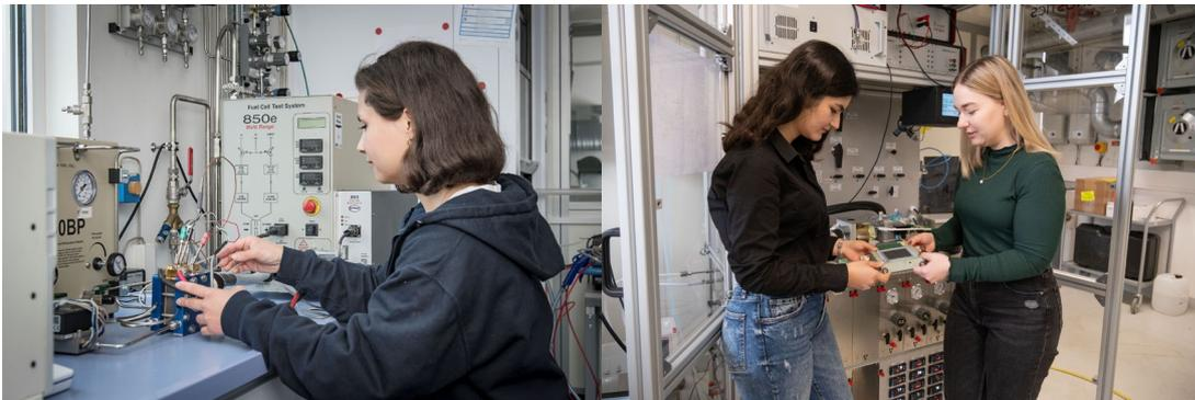
Test von Wasserstoff-PEM-Brennstoffzellen an Prüfständen für Einzelzellen und Short Stacks.
