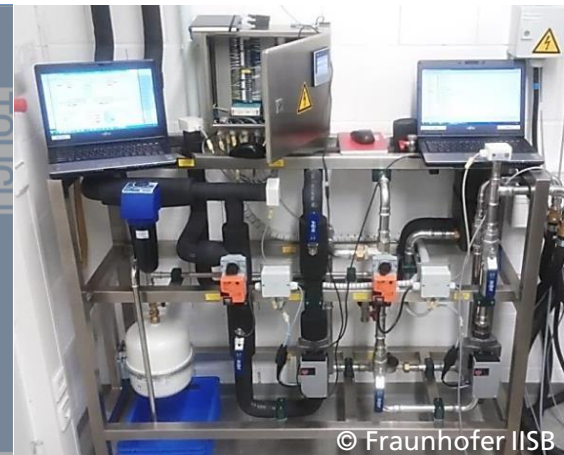
Effiziente Übergabestation zum Kältenetzwerk für Anlagen
