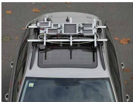
Abbildung 25: Links: Testfahrzeug mit Photovoltaikmodulen unterschiedlicher Technologien (Kooperation mit Webasto). Rechts: Integration organischer Photovoltaikmodule in ein tragbares Solarladegerät (Kooperation mit Fa. Stoll).
