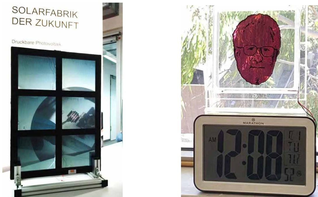
Abbildung 24: Links: Transluzente organische Solarmodule integriert in ein Isolierglasfenster (Kooperation mit Fa. Bischoff Glastechnik AG). Rechts: Freiform-Druck von Photovoltaikmodulen als Portrait-Uhr (Kooperation mit Durst Phototechnik AG).
