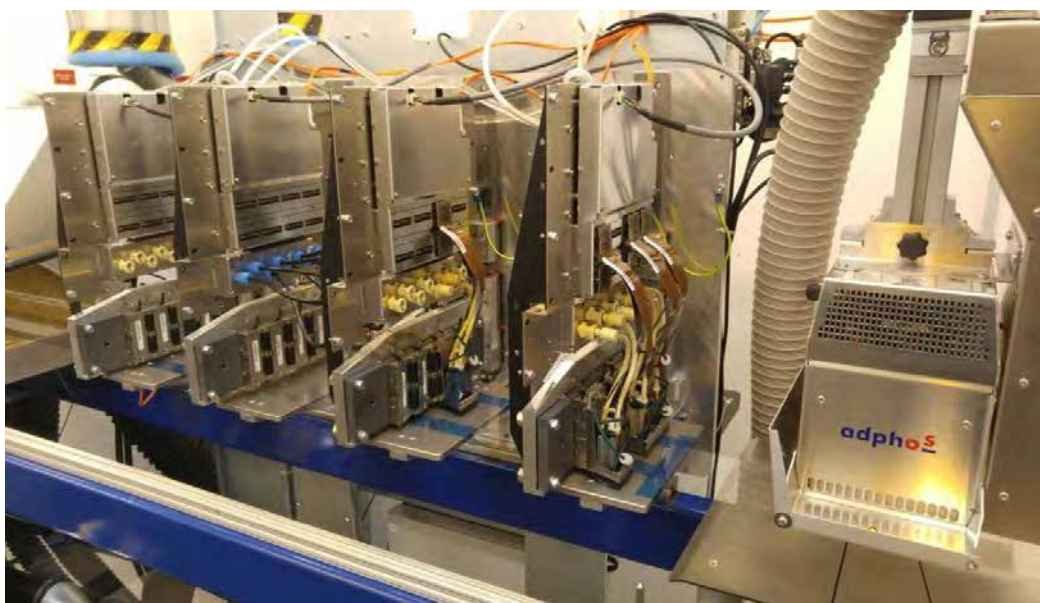
Abbildung 18: R2R-Inkjet Anlage mit vier untereinander synchronisierten Druckstationen. Durch eine 8 kW Infrarotlampe können die Schichten nach dem Druck direkt getrocknet oder gesintert werden.
