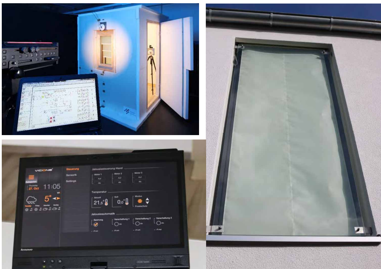
Abbildung 134: i.Solar Control Labordemonstrator am EnCN (©EnCN/Fuchs, links oben), eingebautes Energiesparfenster mit infra-rot-aktiver Beschattung im Real-Demonstrator (rechts), VICIONE Steuerung für das Energiesparfenster (links unten)
