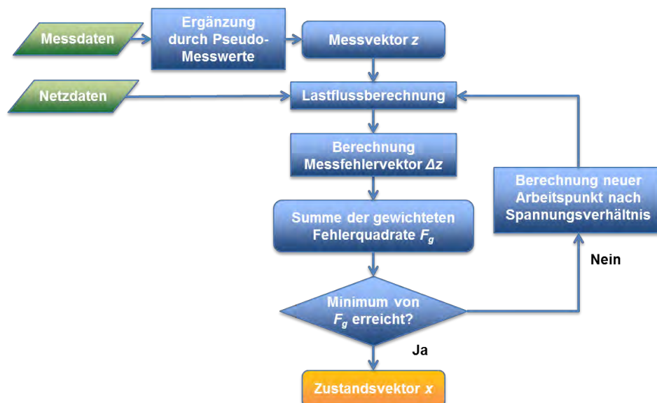
Abbildung 75: Flussdiagramm der State Estimation nach erster Methode unter Verwendung von MATLAB und SINCAL
