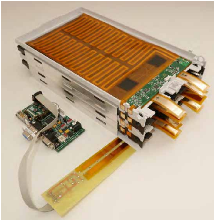
Abbildung 69: Erster Prototypaufbau eines 4-Zellen Batteriemoduls mit dezentraler modularer Batterieüberwachung und integriertem Thermomanagement
