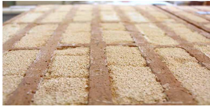
Abbildung 145: Mit Geopolymer-Schaum verfüllte Hochlochziegel
