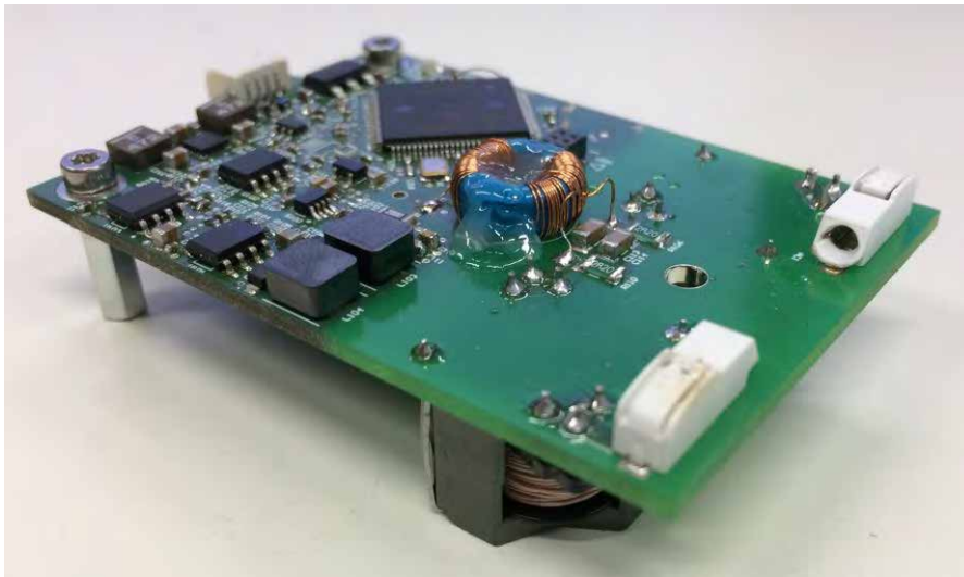
Abbildung 65: Entwickeltes Sende-/Empfangsmodul (65mm x 45mm)
