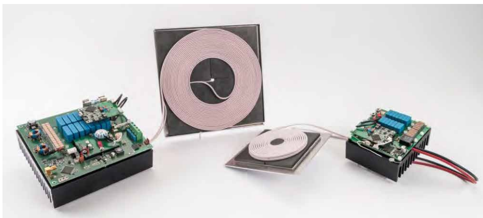
Abbildung 63: Leistungsteile und Übertragungssystem des induktiven Ladesystems
