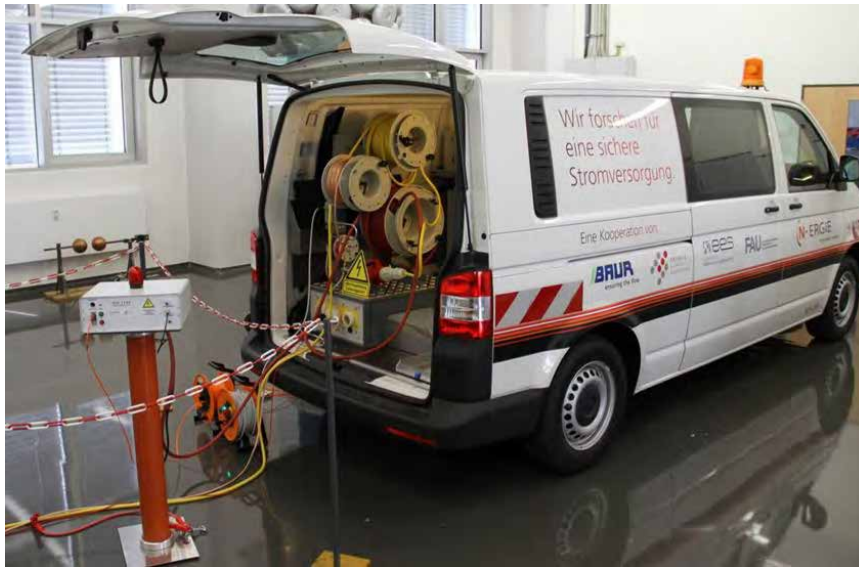
Abbildung 58: Entwickelter Messwagen mit neuartigen und hochspezifischen Mess- und Diagnosefunktionen zur Zustandsbeurteilung von Energieversorgungskabeln des für die Energiewende wichtigen Verteilnetzes
