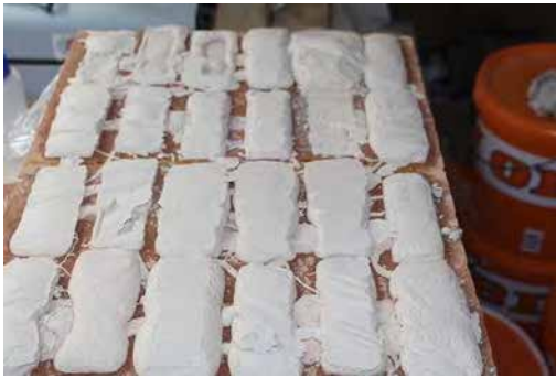
Abbildung 145: Mit Geopolymer-Schaum verfüllte Hochlochziegel
