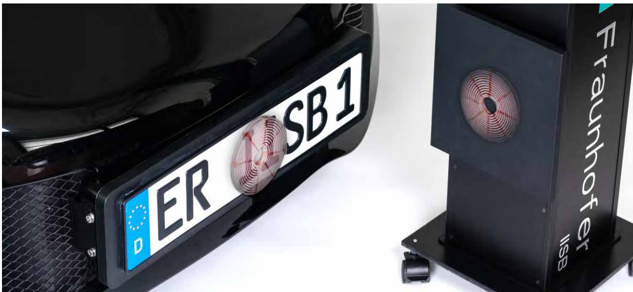
Abbildung 64: Funktionsdemonstrator des induktiven Ladesystems am Testfahrzeug
