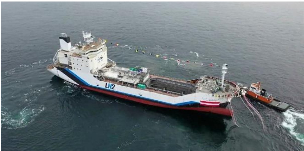
Abb. 41: Japanischer Flüssigwasserstofftanker von Kawasaki Heavy Industries, Foto: Kawasaki Heavy Industries
