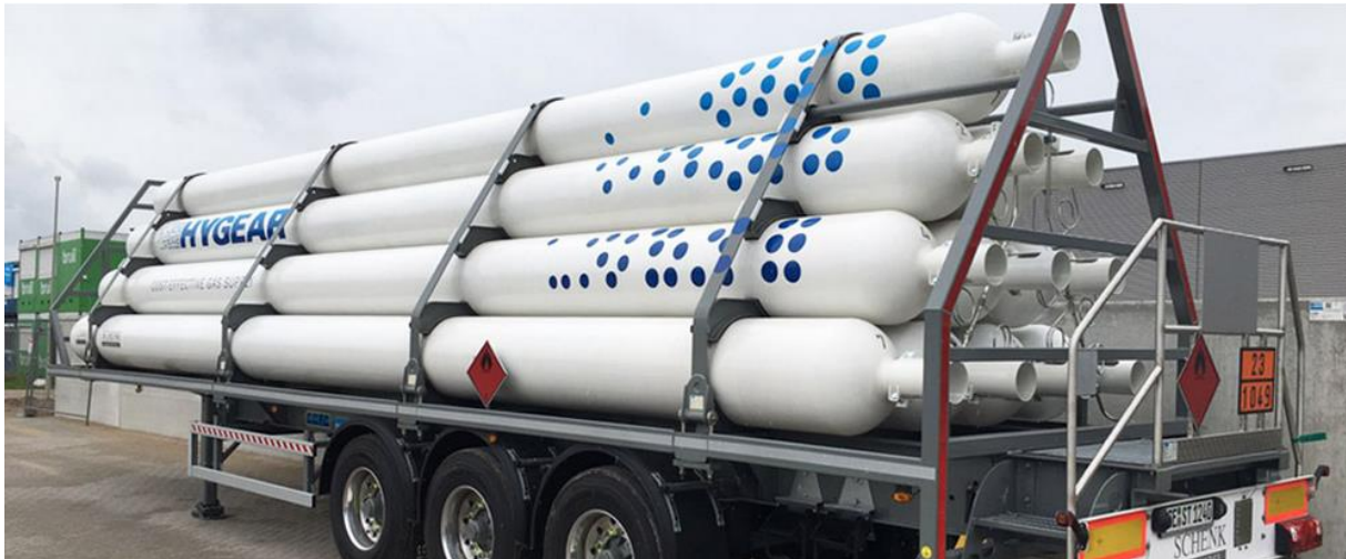
Abb. 42: Hochdruckwasserstoff-Tube-Trailer der Firma HyGear (Bildquelle: fuelcellworks.com) 53
