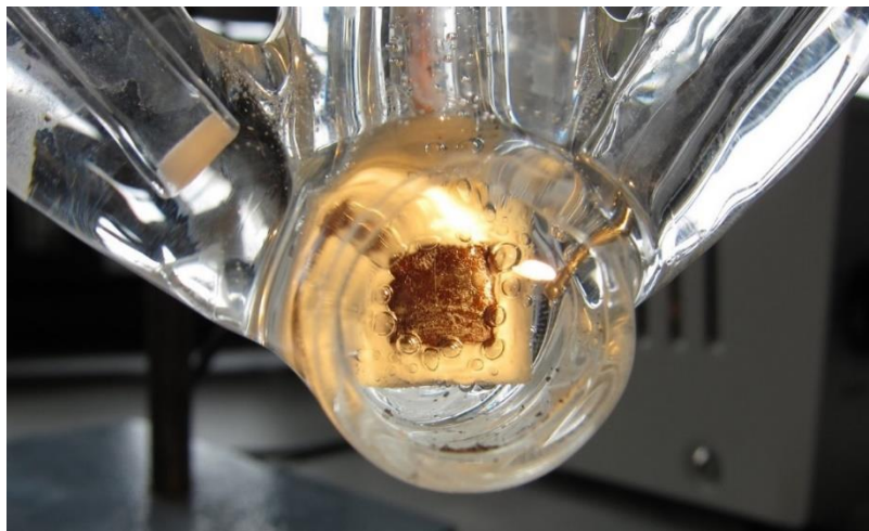
Abb. 23: Elektrochemische Miniaturzelle zur photokatalytischen Wasserspaltung von Bernhard Kaiser, TU Darmstadt. 33
