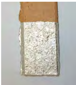
Abb. 6 Links: Die Beschichtung der Ziegeloberflächen mit einer besonderen Pigment-Mischung führt zur Absenkung des Emissionskoeffizienten um bis zu 80,8 %.
