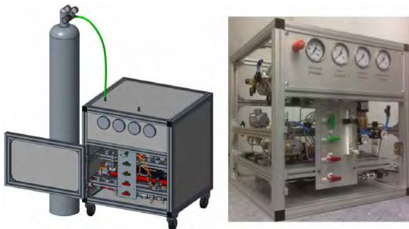
Abbildung 14: Hochdruck-Kraftstoffsystme für Methan und Wasserstoff bis 500 bar
