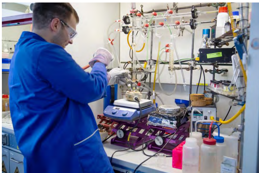
Aufbau für die Synthese von Halbleiter-Nanokristallen
