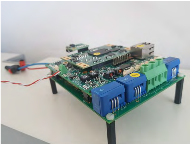
Abb. 27: Eigenentwicklung eines SoC-Systems für die Implementierung der Regelungs- und Ansteuerkonzepte von elektrischen Antriebssystemen
