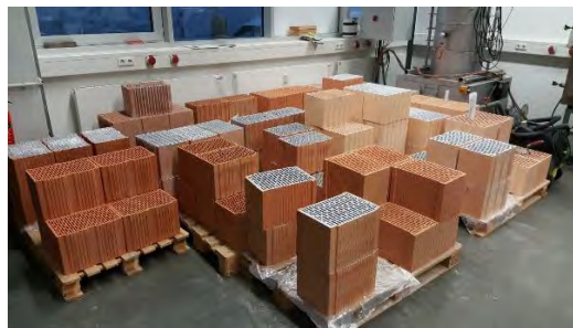
Abb. 6 Links: Die Beschichtung der Ziegeloberflächen mit einer besonderen Pigment-Mischung führt zur Absenkung des Emissionskoeffizienten um bis zu 80,8 %.
