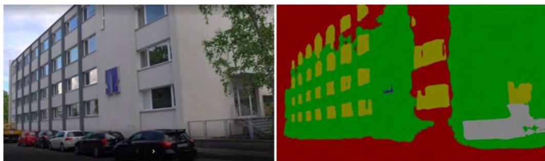
Abb. 15: Ein RGB-Bild eines Gebäudes der TH Nürnberg und die daraus entstandene automatische Segmentierung der Gebäudefassade mit Hilfe eines Deep-Learning-Verfahrens
