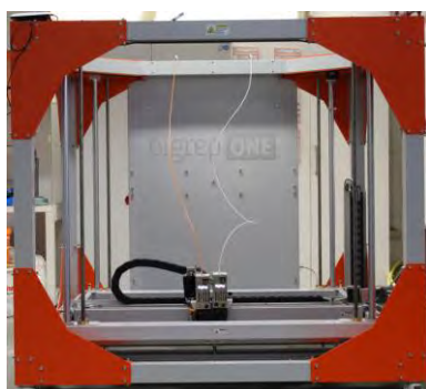
Abb. 8 Links: 3D-Drucker bigrep ONE der Firma bigrep. Das Druckvolumen beträgt 1 m³.
