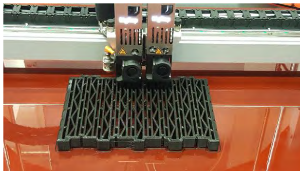
Abb. 8 Links: 3D-Drucker bigrep ONE der Firma bigrep. Das Druckvolumen beträgt 1 m³.
