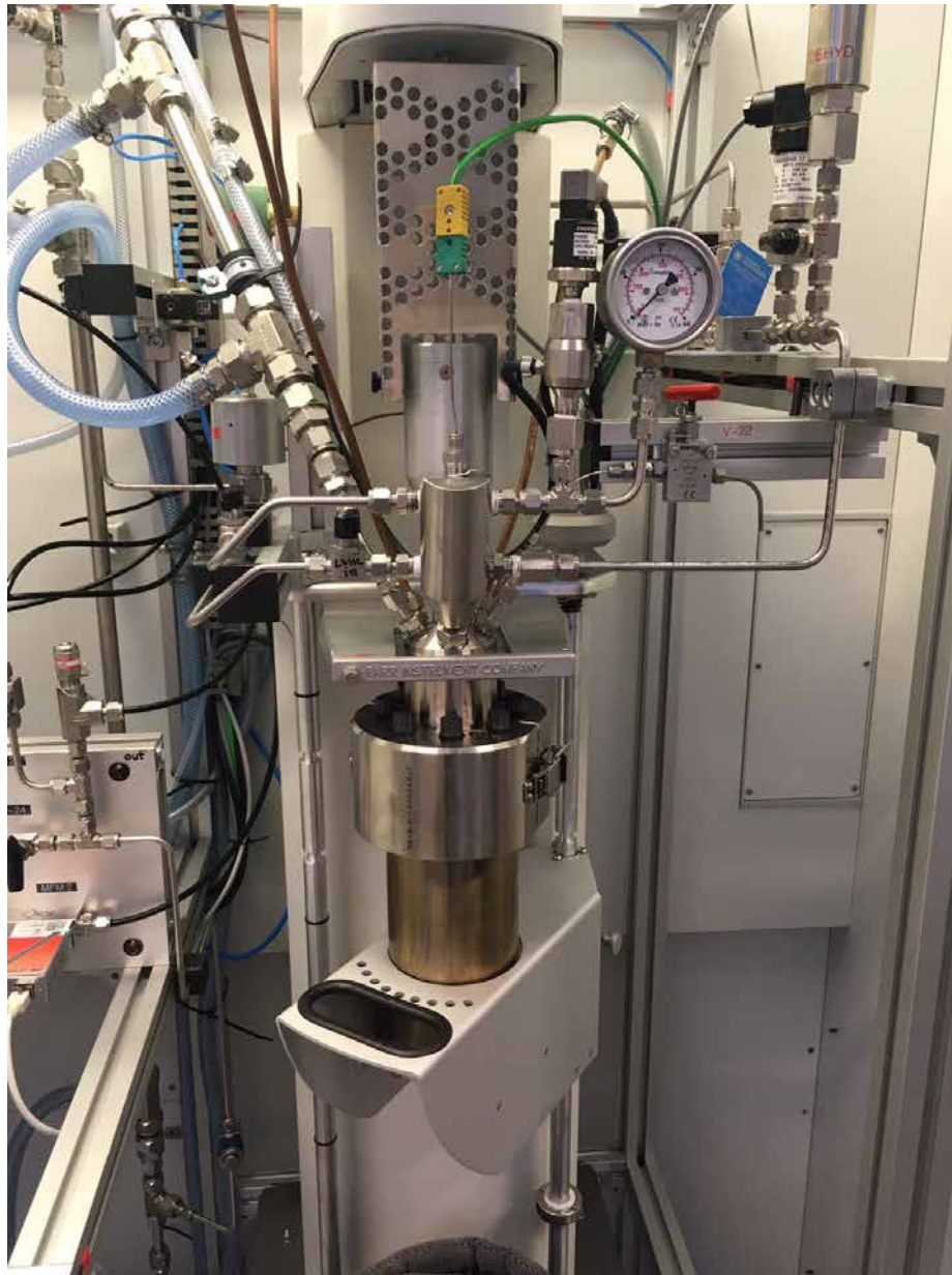
Abbildung 1: Hydrierautoklav für Batch-Untersuchungen zum oneReactor-Verfahren
