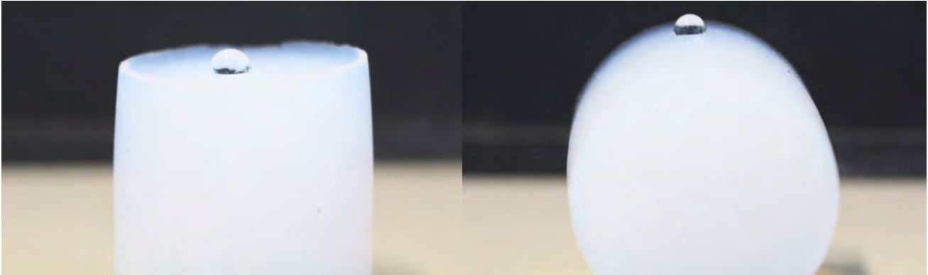
Abb. 5: Durch Anpassung der Synthese-Route konnten Silica-Aerogele mit ausgeprägter Hydrophobie hergestellt werden. Beim Aufbringen von Wassertropfen auf so hergestellte Nullproben stellt sich ein großer Kontaktwinkel zwischen Tropfen und Aerogel-Oberfläche ein.
