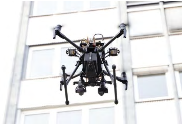
Abb. 14: DJI Matrice M210 mit 4K-RGB-Kamera und hochwertiger IR-Kamera (640 x 480 Pixel, 30fps)
