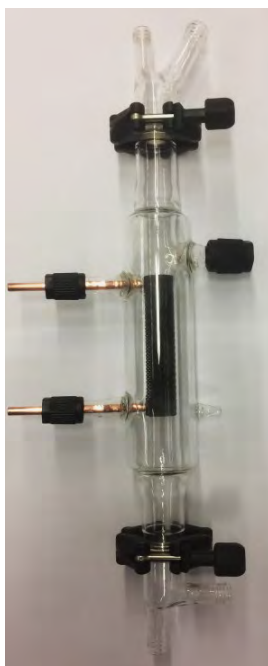
Abbildung 6: Foto des Reaktors für die direkt-elektrisch beheizte LOHC-Dehydrierung
