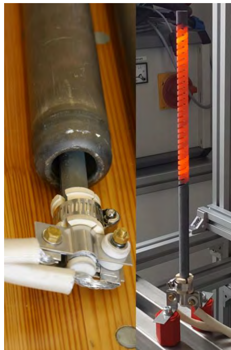
Abbildung 8: links: heißes SiC-Element und Position in der Heatpipe; rechts: Heatpipe-Beheizung mit SiC-Element schematisch
