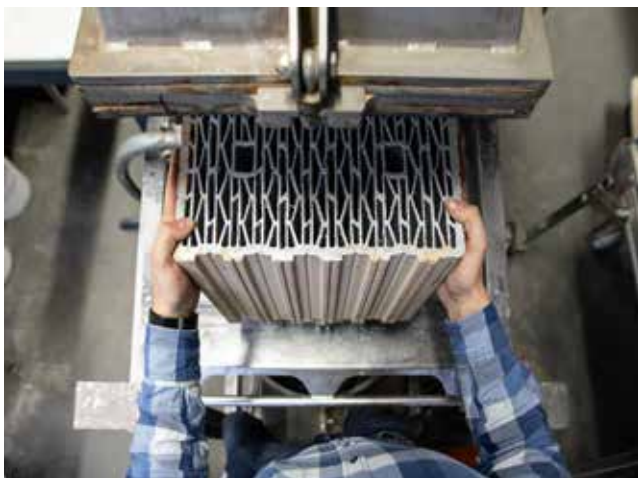
Abbildung 4: Geöffnete Beschichtungskammer mit eingelegtem Hochlochziegel (Links); in inneren Ziegel-Hohlkammern applizierte Wärmedämmbeschichtung (Rechts).
