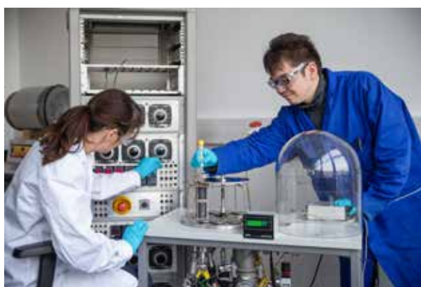
Abbildung 8: Aufdampfanlage für organische Pigmenthalbleiter
