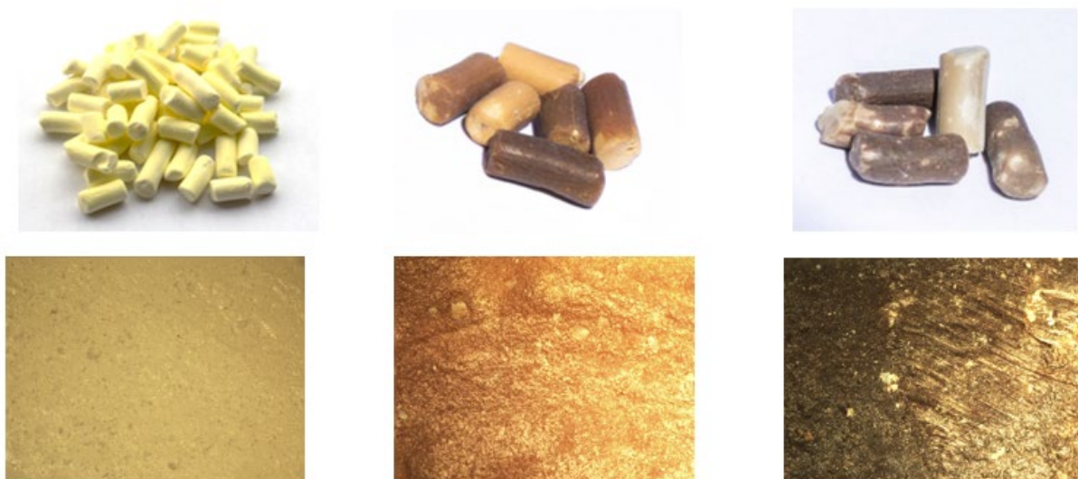
Abbildung 24: Fotos (oben) und lichtmikroskopische Aufnahmen (unten) eines nicht-vergifteten (links), mit \text{H}_2\text{S} -vergifteten \text{In}_2\text{O}_3/\text{ZrO}_2 -Katalysators vor (mitte) und nach (rechts) der Methanolsynthese aus \text{CO}_2 .
