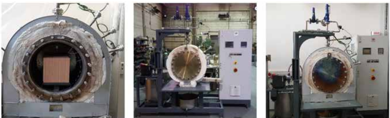
Abbildung 21: Neu gebauter Prüfstand zur zyklischen thermischen Beanspruchung von Wärmespeichermassen.
