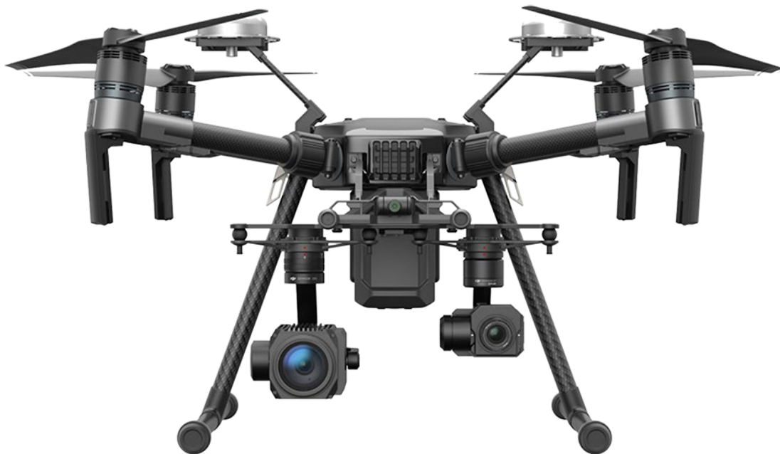
Abbildung 22: DJI Matrice M210 mit 4K-RGB-Kamera und hochwertiger IR-Kamera (640x480 Pixel, 30fps).
