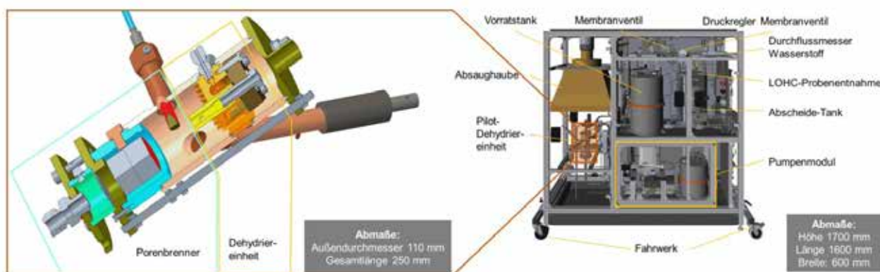
Abbildung 5: System mit einem Porenbrenner als Wärmequelle und der nachgeschalteten Dehydriereinheit (links) sowie neu aufgebaute Laboranlage mit den wichtigsten Komponenten (rechts).
