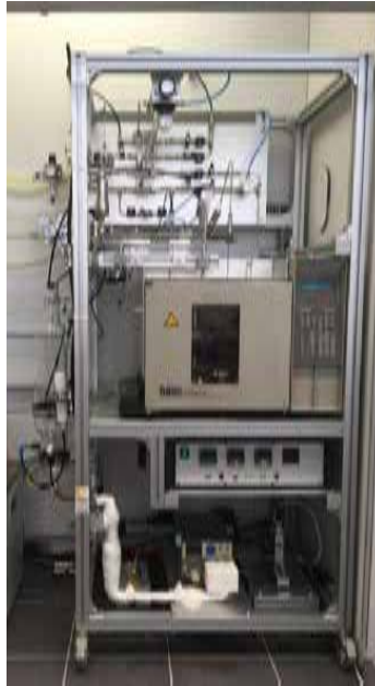
Abbildung 2: Gesamtaufbau Charakterisierungsanlage im Wasserstofftechnikum.
