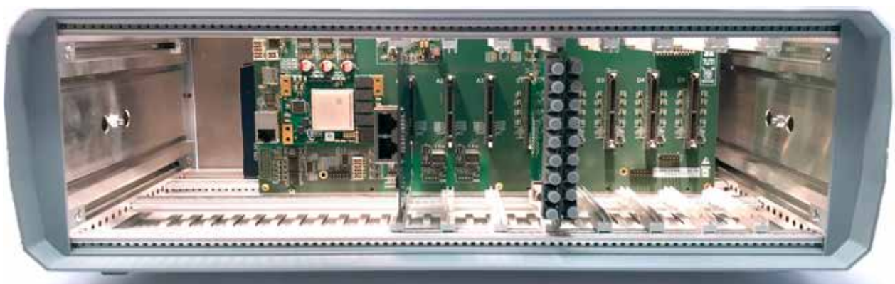
Abbildung 31: UltraZohm: Leistungsstarke Echtzeit-Berechnungsplattform für leistungselektronische Systeme.
