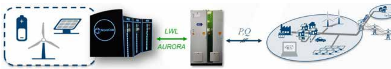
Abbildung 3: Integration simulativer Anlagenkomponenten in das reale Mikronetz durch Hardware-in-the-Loop-Simulation
