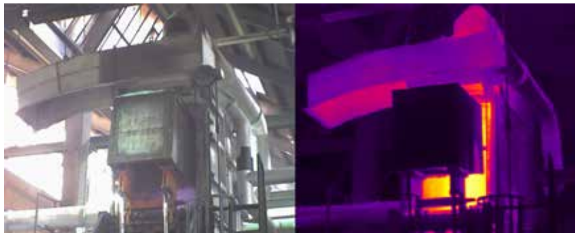
Abbildung 33: IR-Aufnahme eines Aluminium-Schmelzofens.
