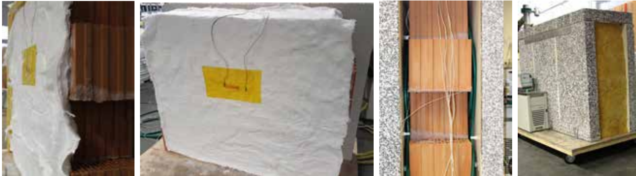
Abbildung 2: Vergleichende Bestimmung des Wärmedurchgangswiderstands einer Ziegelwand, jeweils ohne und mit applizierter Polystyrol-Nanofaser-Matte.
