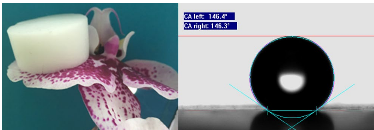
Abbildung 3: Links: Die äußerst geringe Rohdichte der Nanofaser-verstärkten Silica-Aerogel-Monolitthe kann eindrucksvoll durch das Auflegen auf ein Blütenblatt demonstriert werden. Rechts: Die Messung des Kontaktwinkels, welcher ein Wassertropfen auf der Oberfläche einer Aerogel-Probe ausbildet, ist ein Maß für die Hydrophobie des Isolierstoffs. Wird ein Kontaktwinkel von 90^\circ überschritten, im vorliegenden Fall werden 140^\circ erreicht, handelt es sich um hydrophobe, also wasserabstoßende Eigenschaften.
