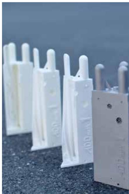
Abbildung 21: Fotografische Darstellung der Entwicklungsschritte des Heatpipe-gekühlten Methanisierungsreaktors ADDmeth; im Vordergrund ist der 5 kW Laborprototyp aus 1.4404 Edelstahl abgebildet
