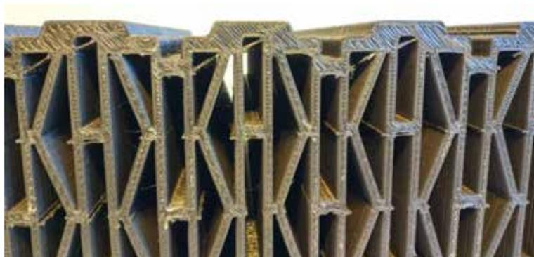
Abbildung 1.13: Detail-Ausschnitt aus der Geometrie eines 3 D-gedruckten „Ersatzziegels“ aus Polymilchsäure (PLA) vor der Schallschutz-Optimierung.
