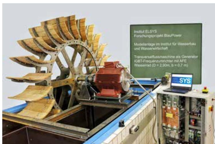
Abbildung 2.5: Modellanlage des Kleinstwasserkraftwerks im Institut für Wasserbau und Wasserwirtschaft (Forschungsprojekt BlauPower).
