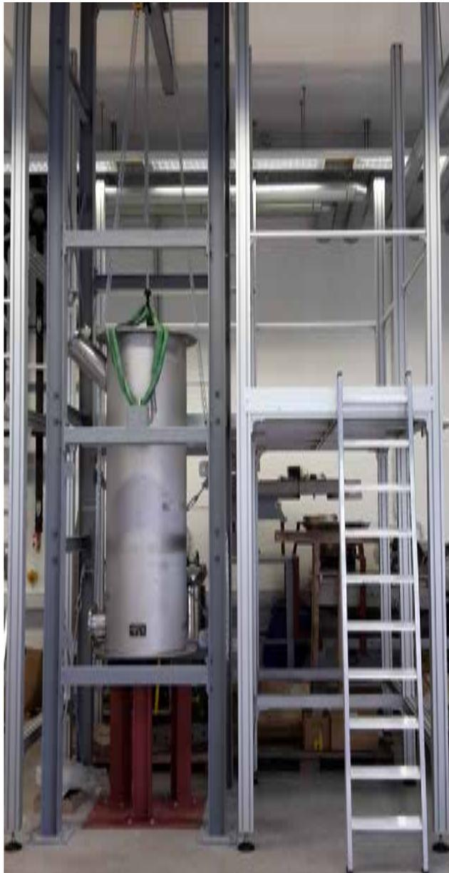
*Abbildung 5: Carbonatspeicher im Speicherhaus*
