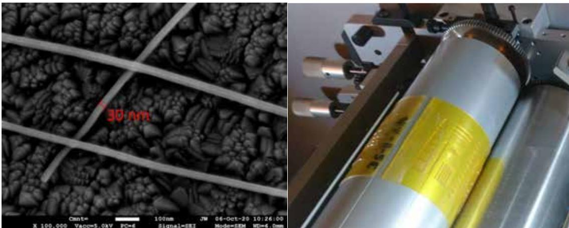
Abbildung 6: Links: REM-Aufnahme eines Netzwerks aus ultradünnen Silbernanodrähten. Rechts: Flexodruck von transparenten, leitfähigen Strukturen aus Silbernanodrähten im Rolle-zu-Rolle-Verfahren.
