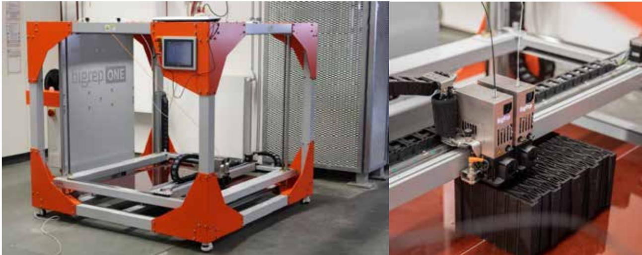
Abbildung 1.15: 3D-Drucker „BigRep One v3“ (l); 3D-Druck eines „Ersatzziegels“ aus Polymilchsäure (r). Der PLA-Ersatz-Ziegel kann im Wärmeprüfstand auf seine äquivalente Wärmeleitfähigkeit vermessen werden.
