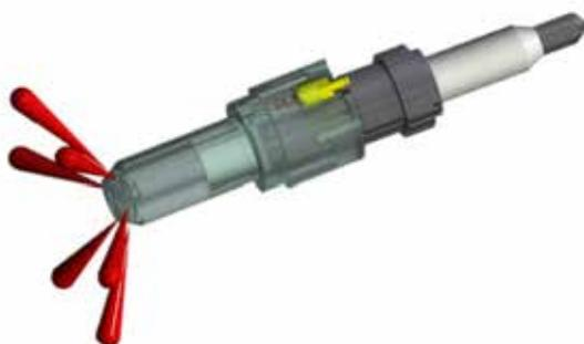
Abbildung 16: Schematische Darstellung einer Vorkammerzündkerze mit Flammenkeulen (rot).
