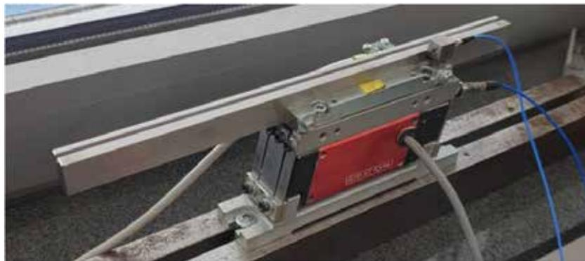
Abbildung 3.1: Linearschwingfördersystem der Firma Afag.
