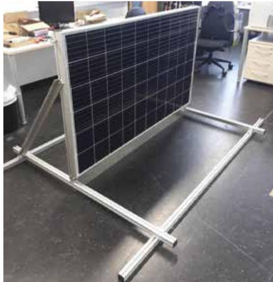
Abbildung 1.25: Montagerahmen für den Versuchsaufbau zum Betrieb einer Mikro-PV Anlage.
