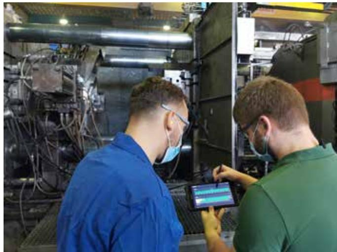
*Abbildung 4.3: Webbasiertes Prozessmonitoring-System im industriellen Einsatz.*
