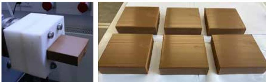
Abbildung 1.5: Extrusion plattenförmiger Tonproben zur Herstellung von Laborziegeln (l). Frisch extrudierte, pressfeuchte Ziegelrohlinge (r).
