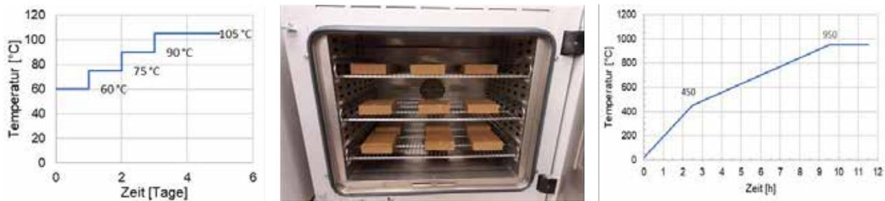
Abbildung 1.6: Temperatur-Zeit-Programm zur schonenden Trocknung der Tonrohlinge bis zur Gewichtskonstanz (l); Lagerung der Tonrohlinge im Trockenschrank (m) und verwendete Brennkurve für das Sintern der Laborziegel (r).
