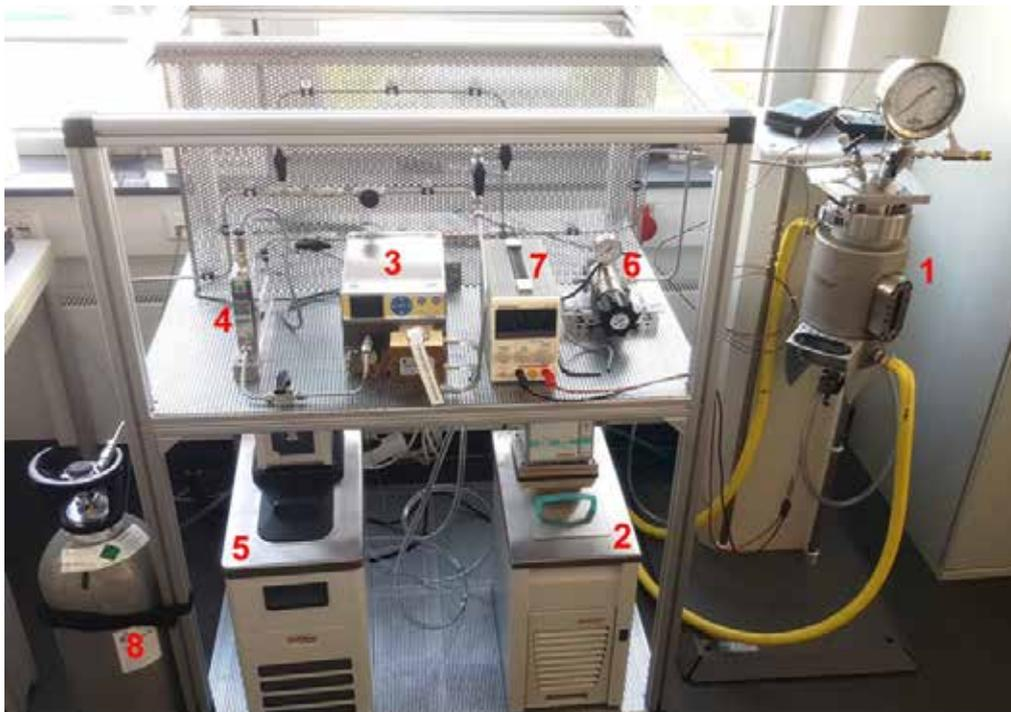
Abbildung 1.4: Gesamtansicht des neuen Autoklav-Aufbaus zur verbesserten Trocknung von Silica-Aerogelen: 1 = Druckgefäß; 2 = Heizkreislauf des Druckgefäßes; 3 = Hochdruckpumpe; 4 = Durchflussmengenregler; 5 = Kühlkreislauf der Hochdruckpumpe; 6 = beheiztes Überströmventil; 7 = Elektrische Widerstandsheizung des Bodenablassventils; 8 = CO<sub>2</sub>-Versorgung.
