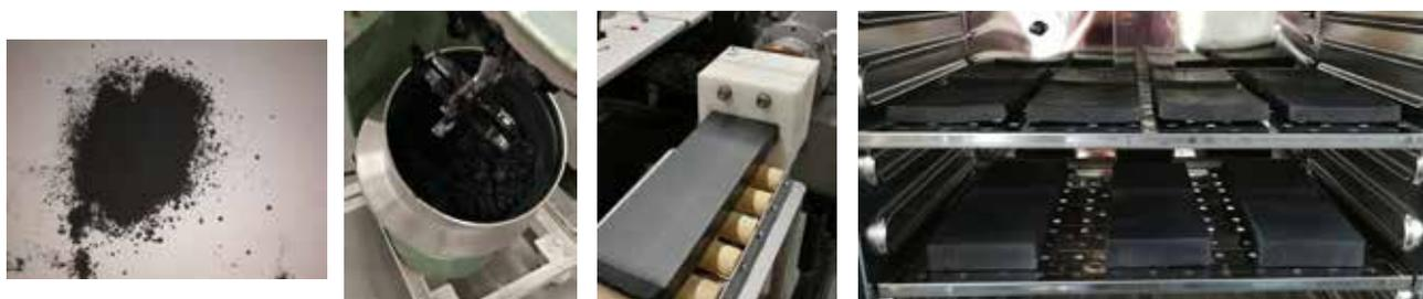
*Abbildung 1.16: Erprobung von Carbon Black (Ruß) als ausbrennbares Nano-Porosierungsmittel (Links); Einarbeitung von Carbon Black in Ziegelton mittels Eirich-Mischer (Mitte links); Extrusion von Ziegelton mit Carbon Black (Mitte rechts); extrudierte Tonplatten mit Carbon Black im Trockenschrank (r).*
