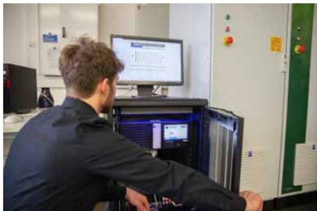
Abbildung 1: Echtzeitsimulator für Power-Hardware-in-the-Loop Anwendungen
