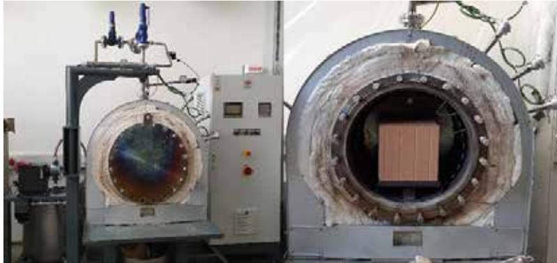
Abbildung 18: Prüfstand für zyklische Abschreckversuche an handelsüblichen Ziegelproben
