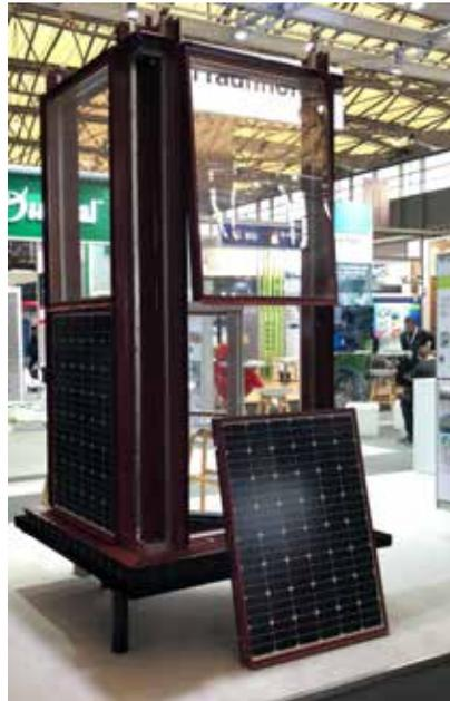
Abbildung 1.21: Mock-up der entwickelten modularen Technikfassade mit integrierten Photovoltaik-Modulen.
