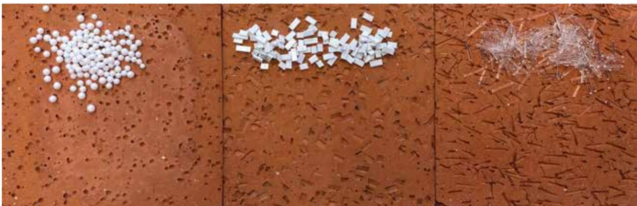
Abbildung 1.7: Fertig gesinterte, porosierte Laborziegel mit sphärischen (l), quaderförmigen (m) und zylindrischen (r) Poren und zugehörige Porosierungsmittel (EPS, HIPS und PLA).
