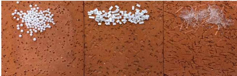
Abbildung 17: Fertig gesinterte, porosierte Laborziegel mit sphärischen (Links), quaderförmigen (Mitte) und zylindrischen (Rechts) Poren und jeweils zugehörige Porosierungsmittel
