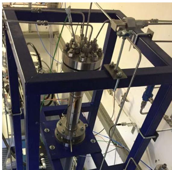
Abbildung 6: Eine neue Art von Kolben-Wasserstoff Kompressor Prototype
