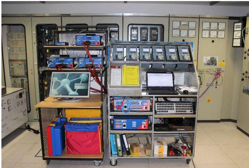
Abbildung 2: Schutzgerätstand auf Basis von Digitalschutzgeräten aktuellster Generation, im Hintergrund Kraftwerks- und Netzmodell
