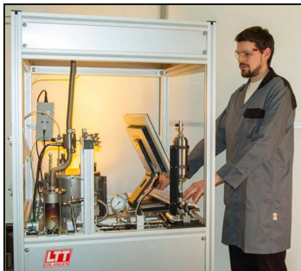
Abbildung 7: Erster Prototyp einer LOHC-Dehydriereinheit mit einem Porenbrenner als Wärmequelle
