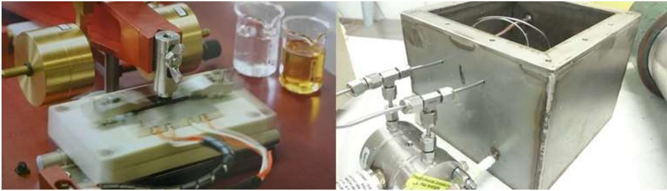
Abbildung 2: Tribometer zur Bestimmung des Reib- und Verschleißkoeffizienten (links) sowie Kapillar-Viskosimeter zur Bestimmung der Viskositäts-Temperatur-Charakteristik (rechts) von Arbeitsfluid-Schmieröl-Paarungen
