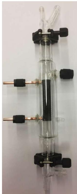
Abbildung 3: Foto des Reaktors für die direkt-elektrisch beheizte LOHC-Dehydrierung
