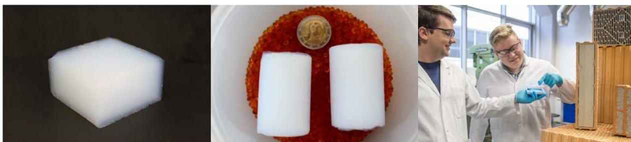
Abb. 8: Beispiele für synthetisierte Silica-Aerogel Monolithe. Die leichte Blaufärbung entsteht durch Raleigh-Streuung und ist ein Indiz für die vorliegende Mikrostruktur, die sich aus den nur wenige Nanometer großen Primär- und Sekundärpartikeln aus Silikat-Einheiten aufbaut. Ein mögliches Anwendungsbeispiel ist die Verfüllung von Ziegeln.
