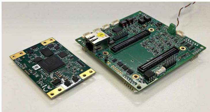
Abb. 22: Eigenentwicklung eines SoC-Systems für die Implementierung der Regelungs- und Steuerkonzepte von elektrischen Antriebssystemen
