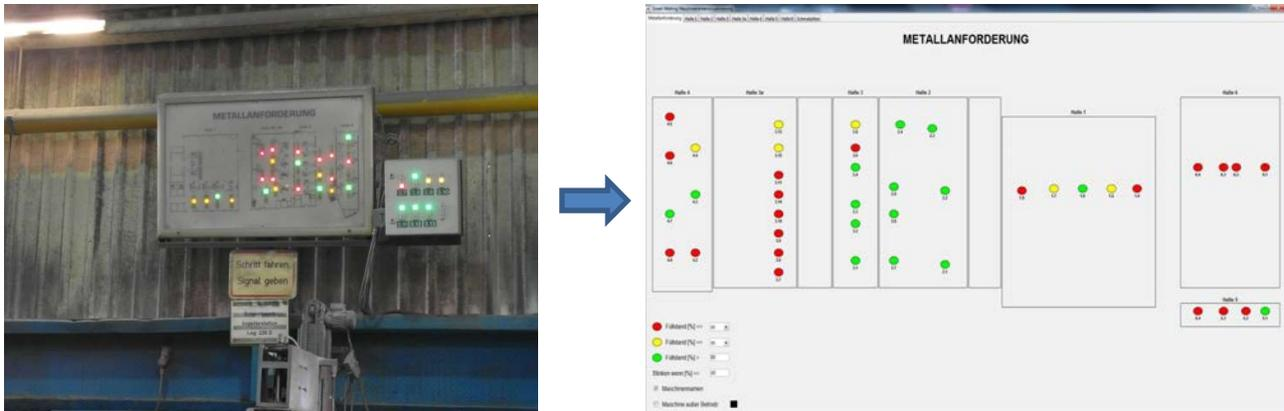
Abb. 27: Anzeigetafel und Online-Anzeige der Füllstände der Druckgussmaschinen beim Kooperationspartner B
