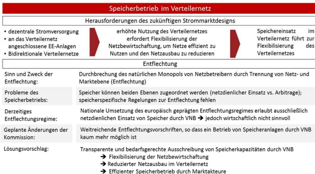
Abbildung 6: Speicher im Verteilernetz: Rechtliche Probleme und Lösungsansätze. Eigene Darstellung.
