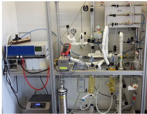
Abbildung 2: Links – Brennstoffzellenmessstand zur Untersuchung von Direkt-PEM-Brennstoffzellen; Rechts – Strom-Spannungs-Kurve von 2-Propanol, T = 85\text{ °C} .
