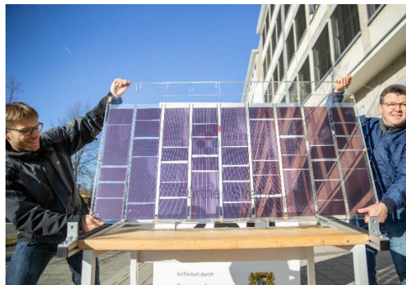
Abbildung: Glasvordach mit einlamierten semitransparenten OPV-Modulen
