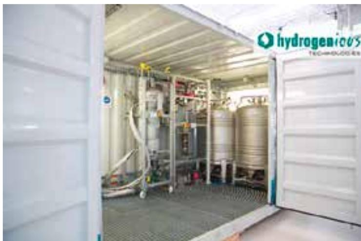
**Abbildung 24:** Pilotanlage zur Speicherung von Wasserstoff in LOHC (Hydrogenious StorageBOX)
