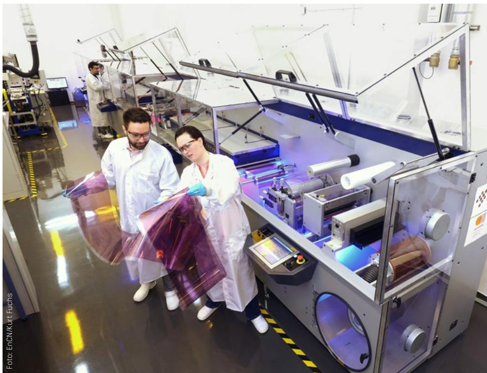
„Solarfabrik der Zukunft“: Beschichtungslinie für die Herstellung organischer Photovoltaik-Module am ZAE-Standort Nürnberg.
