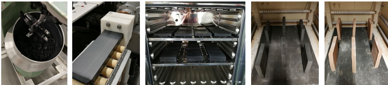
Abbildung 10: Nanoporosierung einer Tonmischung mit „Carbon Black“ für die Herstellung höchstwärmedämmender Ziegel (von Links nach Rechts); Eirich-Mischer, Laborextruder, Trockenschrank, Proben im Ofen vor dem Brand und Proben im Ofen nach dem Brand.
