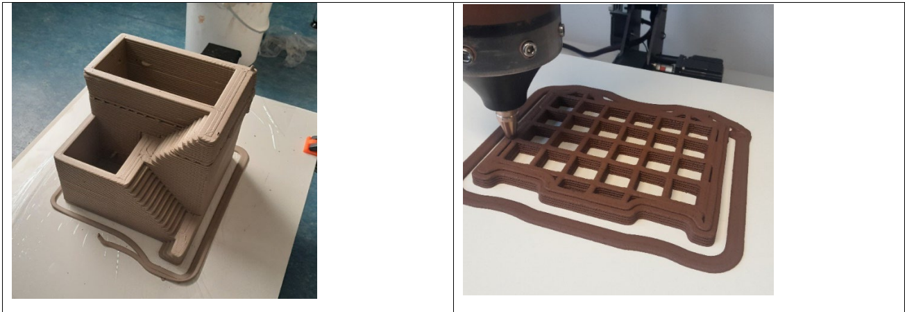
Abbildung 1: Beispiele für durchgeführte 3D-Druck-Bauteile: Formteil aus Cordierit (links oben), Wärmeleitplatte zur Messung der Scherben-Wärmeleitfähigkeit und weiterer Materialparameter aus Steinzeug-Ton (rechts oben), Design-Studie zum 3D-Druck aus Fein-Steinzeug (links unten) und Hochlochziegel-Lochbildentwicklung für Parameterstudien aus Ziegel-Ton (rechts unten).
