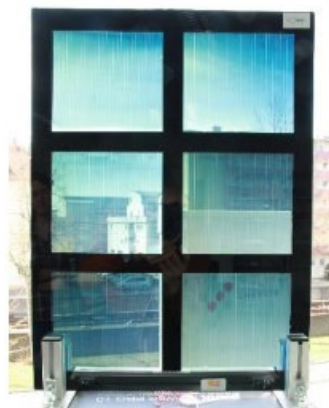
Abbildung 3: Fensterelement mit integrierten semitransparenten OPV-Modulen (FAU-1).
