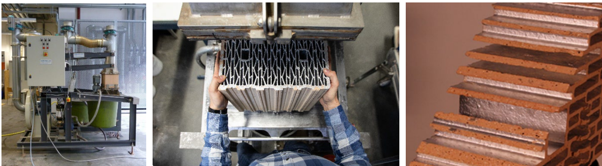
Abbildung 5: Beschichtungsanlage mit eingelegtem Hochlochziegel (Links und Mitte); aufgeschnittener, im inneren Lochbild beschichteter Hochlochziegel (Rechts).
