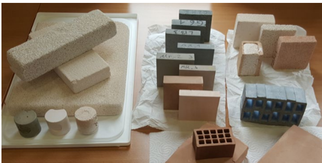
Abbildung 12: Eine Auswahl verschiedener, durch Gießformgebung und Extrusion hergestellter Geopolymer-Proben. Sowohl hochwärmedämmende Geopolymer-Schäume, als auch hochfeste Geopolymere und Hohlwaren können aus Baureststoffen kalterhärtend hergestellt werden.
