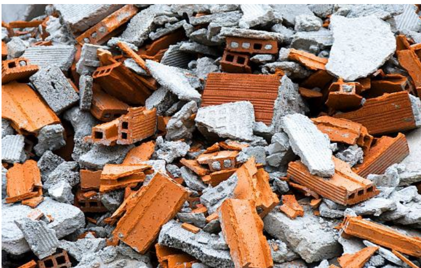
Eingesetzter Sekundärrohstoff (Recycling-Bauschutt) (links) für den 3D-Druck von Gebäuden im Layer-Verfahren (rechts)
