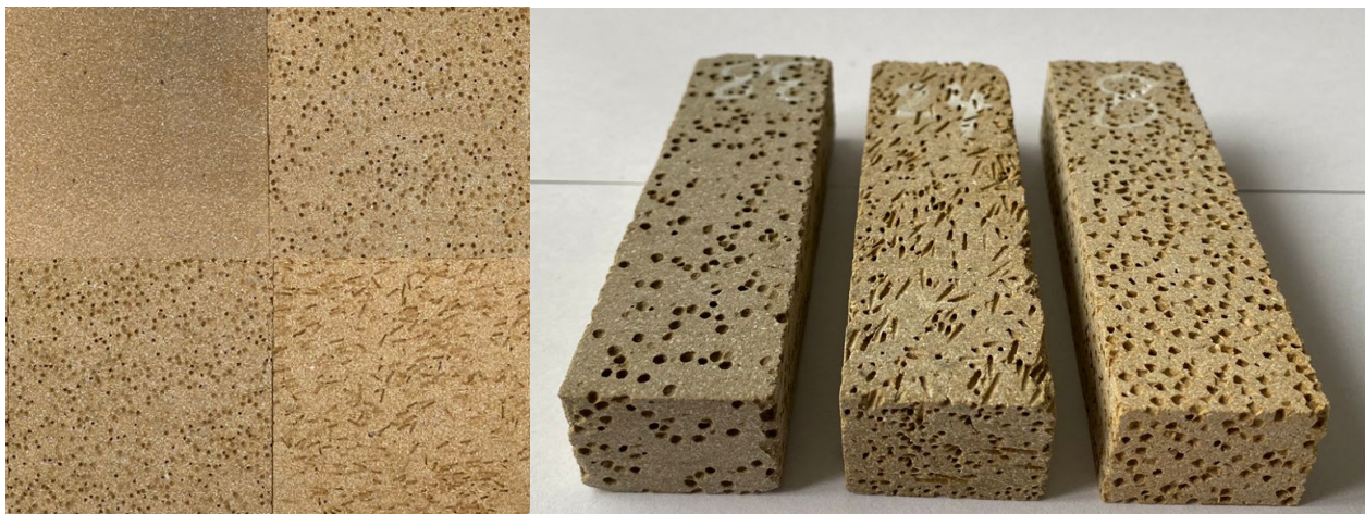
Bilder 4 und 5: Mit unterschiedlichen Porenformen ausgerüstete plattenförmige Cordierit-Probekörper mit den Abmessungen ( L \times B \times H ) 100 mm x 100 mm x 25 mm (l). Mit unterschiedlichen Porenformen ausgerüstete Cordierit-Probestäbe mit den Abmessungen ( L \times B \times H ) 120 mm x 25 mm x 20 mm (r).
