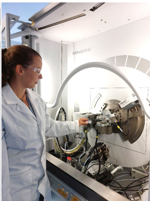
Pulverdiffraktometer mit In-situ bzw. Operando-Kammern (T = - 150 – 450 °C)
