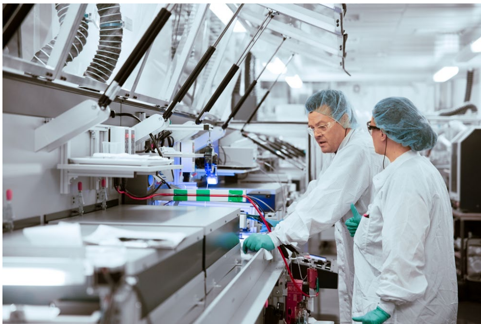
Abbildung 3: Rolle-zu-Rolle Anlage für den Druck von organischer Photovoltaik in der Solarfabrik der Zukunft
