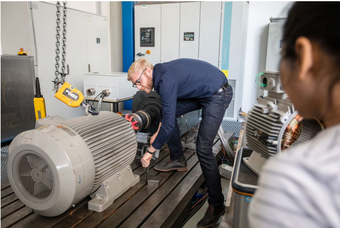
Motorenprüfstand für Leistungsbereiche bis 400 kW, Drehmomente bis 5000 Nm und Drehzahl bis 3300 U/min
