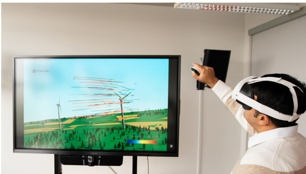
VR-Analyse der Nachlaufströmung einer Windkraftanlage
