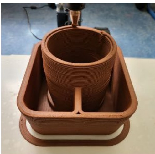
3D-gedruckte Dachentlüftung / Ansicht von oben (l) und von unten (r) (Druckzeit 15 min), eine Nacharbeit ist nicht erforderlich.
