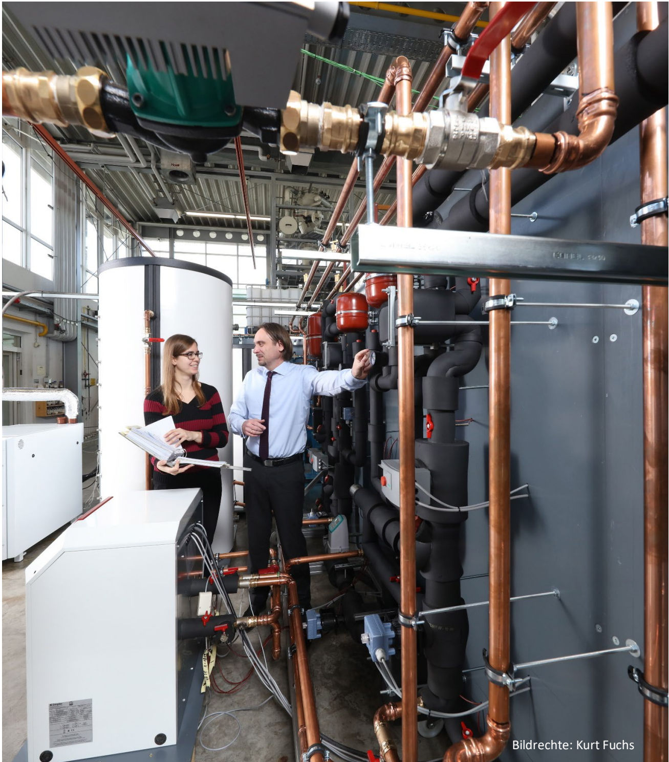
Emulationsprüfstand für Komponenten der technischen Gebäudeausrüstung
