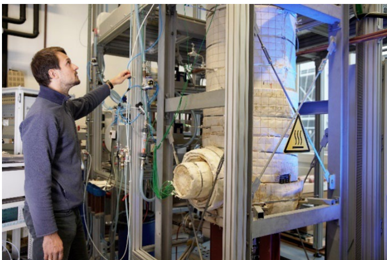
100 kWh Pilot-Carbonatspeicheranlage im Speicherhaus des EnCN
