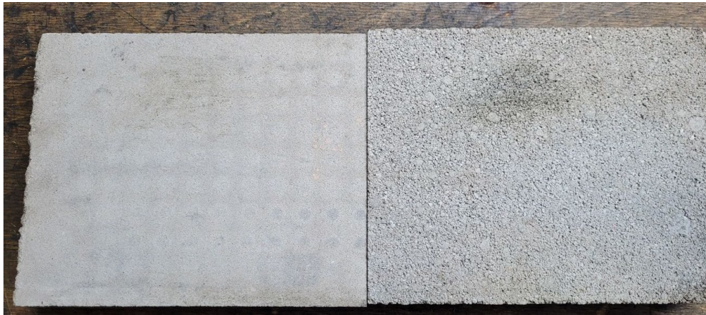
Pressplatten aus Recyclingstoffen hergestellt in ersten Technikumsversuchen bei unserem Projektpartner Wolfshöher Tonwerke
