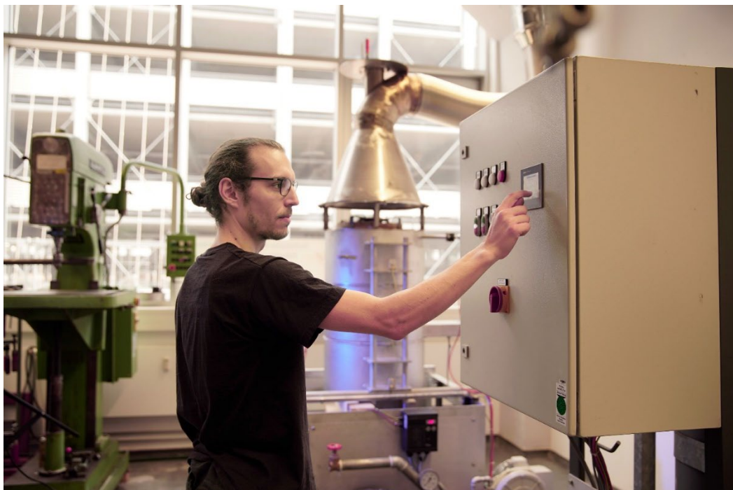
Bild 6: Im Wirbelschicht-Reaktor erfolgt das Sintern von kleinsteiliger Elektrokeramik bei 1350 °C im Schwebezustand.
