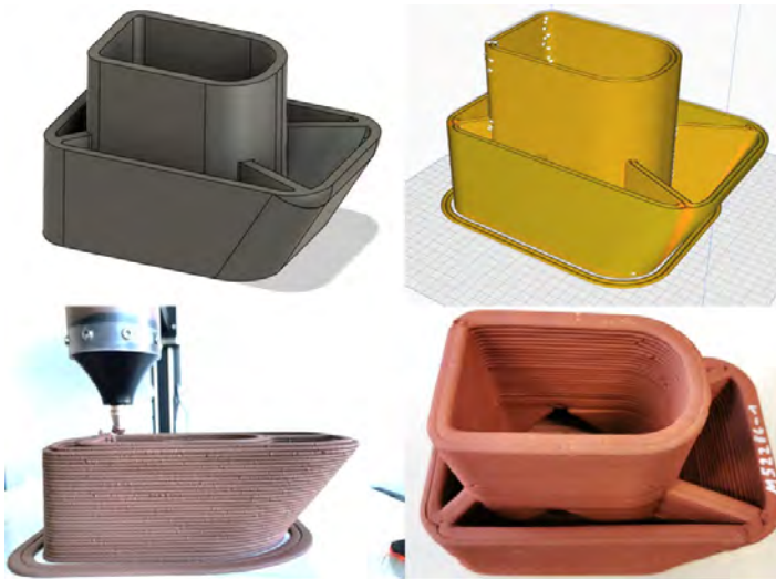
Von der digitalen Planung zum realen 3D-Druck: CAD-Modell (oben links), Slicing-Vorschau (oben rechts), additiver Fertigungsprozess
