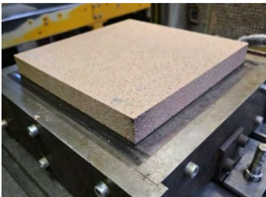
Pressplatten aus Recyclingstoffen hergestellt in ersten Technikumsversuchen bei unserem Projektpartner Wolfshöher Tonwerke
