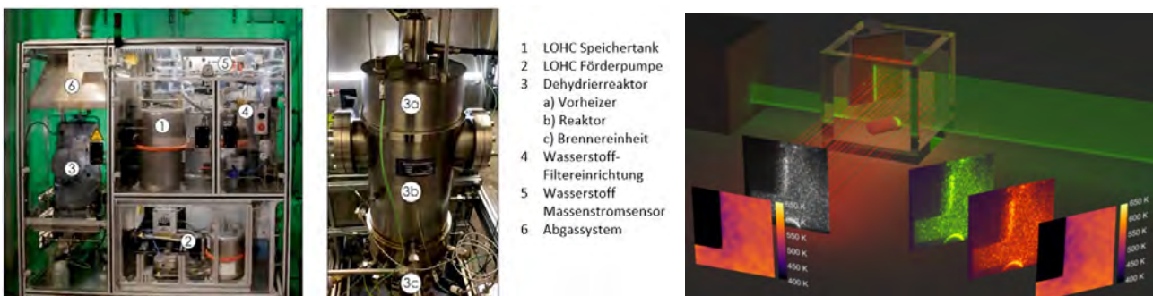
Dehydrieranlage und Reaktor sowie Schema der Laserinduzierten Phosphoreszenz zur Temperaturbestimmung.
