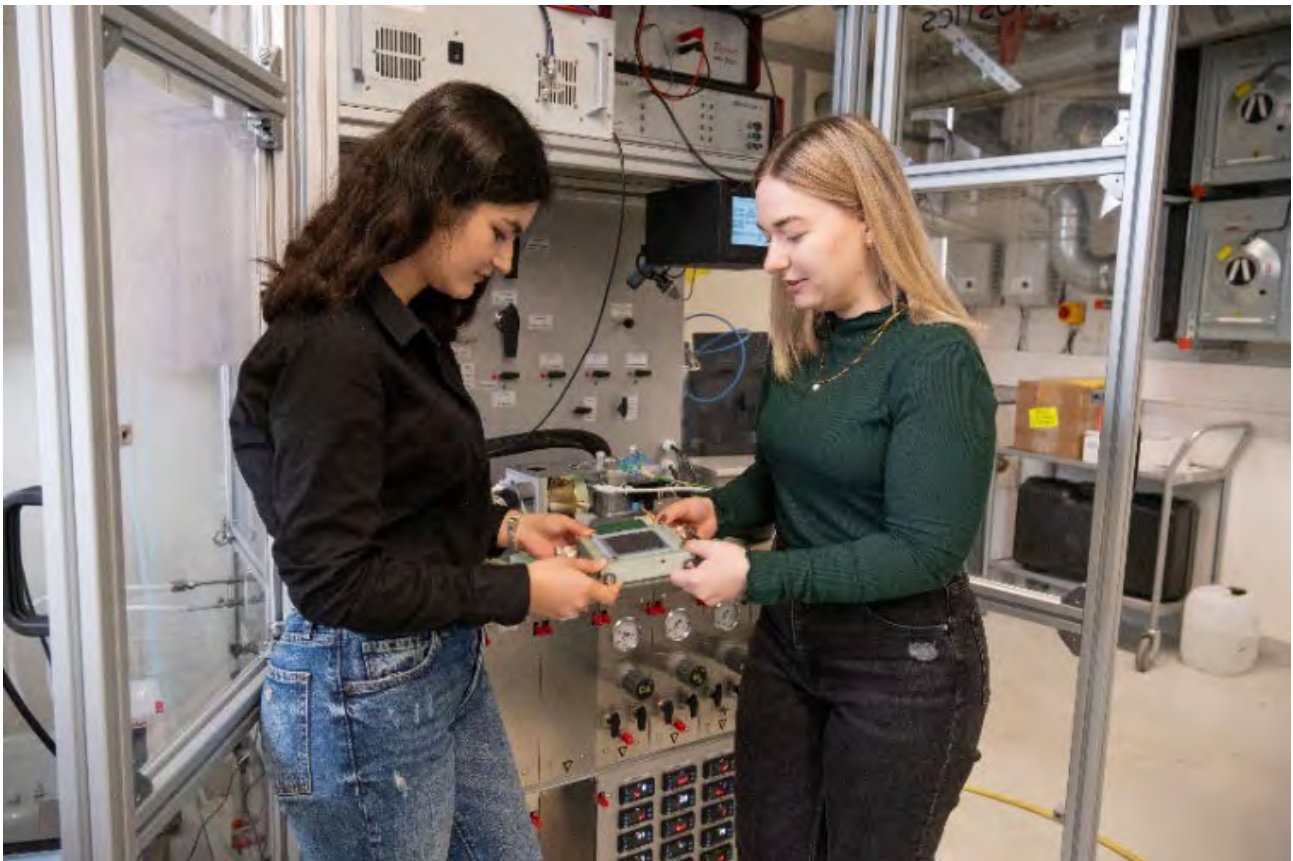
Neuer Prüfstand zur Charakterisierung und Lebensdaueruntersuchung von PEM-Brennstoffzellen bis 2,3 kW el .
