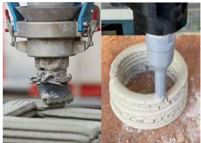
Gedrucktes Bauteil aus Recyclingbaustoffen
