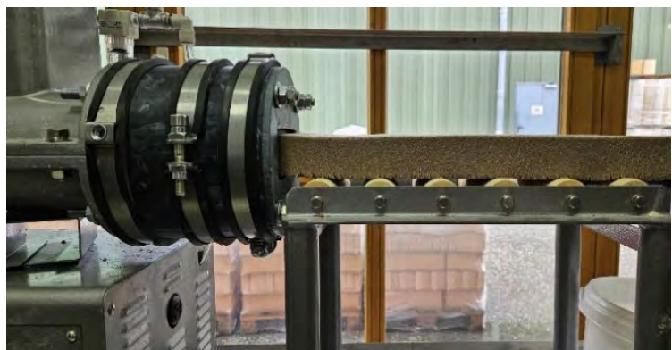
Geopolymer Extrusionsversuche im Labormaßstab
