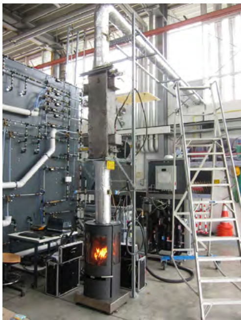
Abbildung 2: Plattenelektrofilter im Projekt I_WESP
