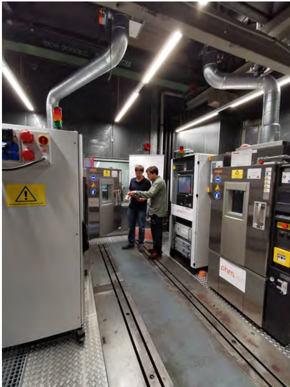
Versuchsfeld mit vollautomatisierten Prüfständen für Batteriesysteme am Campus Future Driveline
