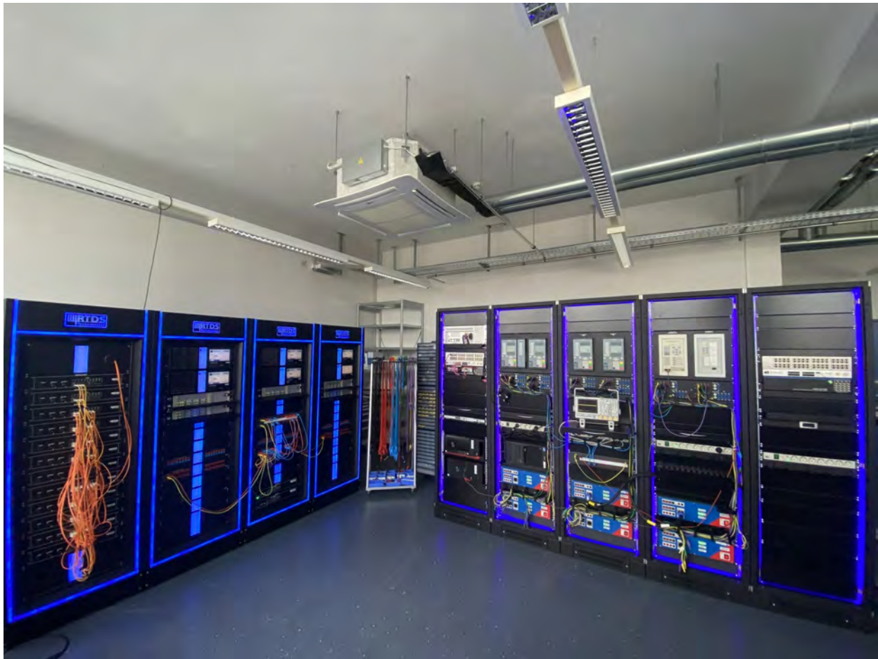
Echtzeitsimulatoren der Firma RTDS Technologies (links) und von OPAL-RT (rechts) sowie Schutzgeräte (rechts) im Echtzeitlabor des LEES am EnCN
