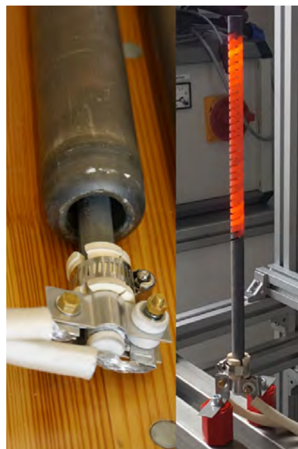
Abbildung 23: links: heißes SiC-Element und Position in der Heatpipe; rechts: Heatpipe-Beheizung mit SiC-Element schematisch
