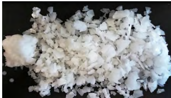
Abbildung 16: Magnesiumchloridhydrat nach dem Einsatz als thermochemischer Energiespeicher; infolge der Hydratisierung treten Agglomerationseffekte zwischen den Partikeln auf (links im Bild), welche die Zyklenfähigkeit reduzieren
