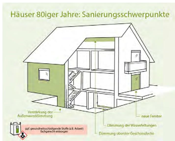
Abbildung 60: Typisches Haus aus den 80er Jahren mit den häufigsten Sanierungsproblemen [4]
