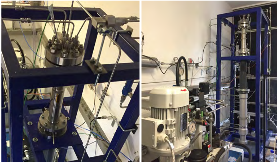
Abbildung 21: Eine neue Art von Kolben-Wasserstoff Kompressor Prototyp und die gesamte Anlage
