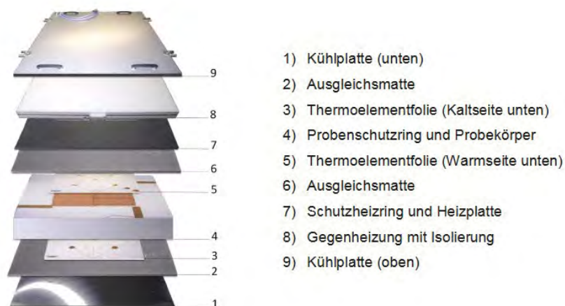
Abbildung 8: Aufbau des Einplatten-Wärmeprüfstandes zur Messung der äquivalenten Wärmeleitfähigkeit von Ziegeln
