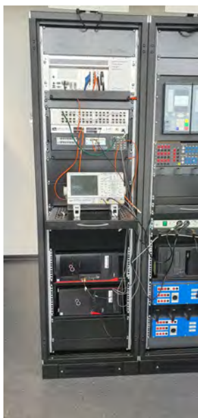
Abbildung 4: Vorderseite des CHIL Racks mit den Simulatoren von Speedgoat und OPAL-RT
