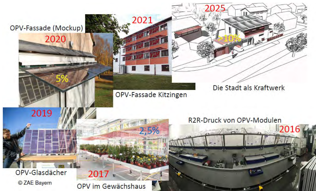
Abbildung 18: Erfolgreiche Aufskalierung von Organischer Photovoltaik (OPV) im Rahmen des Projekts EET: basierend auf dem Rolle-zu-Rolle-Druck der Module und ihrer Integrierbarkeit in mannigfaltige BIPV-Anwendungen bietet diese Technologie ein immenses Potential als urbanes Kraftwerk im Rahmen der Energiewende. Die jeweiligen Effizienzwerte der Module sind in % angegeben.
