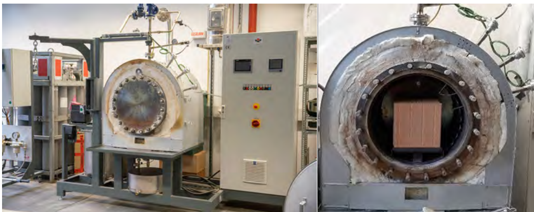
Abbildung 51: Prüfofen bis 2 bar Innendruck für die Durchführung zyklischer Aufheiz- und Abschreckversuche an handelsüblichen Mauerziegeln als Speichermasse.
