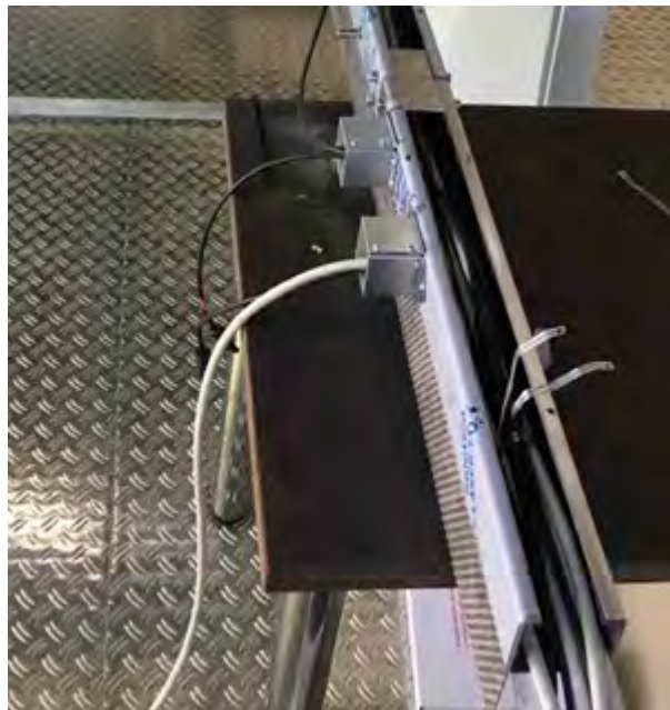
Abbildung 32: Prototyp einer offenen Lisene mit Kabelführung – zu erkennen sind: Aus- und Einfädungen sowie die Befestigung der Kabel an einer Zugentlastung
