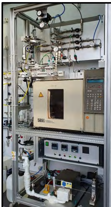
Abbildung 2: Gesamtaufbau der Laboranlage im Wasserstofftechnikum
