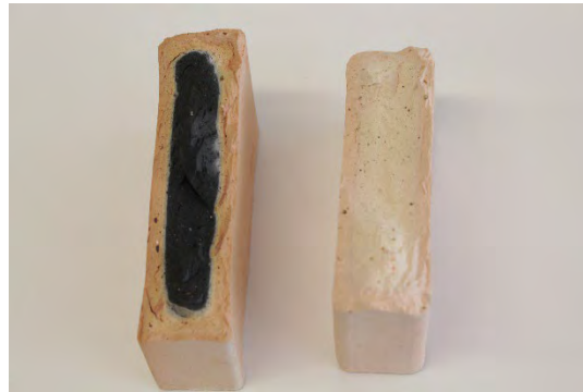
Abbildung 19: Optischer Vergleich zweier Probekörper aus Ziegelkeramik. Dem Ton wurde bei der Herstellung des links abgebildeten Probekörpers „Carbon Black“ als Porosierungsmittel zugesetzt. Beim dem rechts abgebildeten Probekörper wurde zusätzlich noch Papierfangstoff zugegeben und beide Probekörper wurden mit derselben Brennkurve gesintert. Der „schwarze Kern“ ist auf unverbranntes „Carbon Black“ zurückzuführen. Aufgrund einer unzureichenden Sauerstoff-Diffusion konnte das „Carbon Black“ nicht ausbrennen. Bei der rechts gezeigten Ziegelkeramik konnte das „Carbon Black“ infolge der zusätzlichen Zugabe von Papierfangstoff sehr gut ausbrennen.
