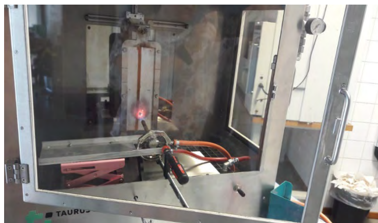
Abbildung 11: Kleinbrenner-Versuch an beschichteter Ziegelprobe. Die Beschichtung konnte nicht entzündet werden, zeigte kein Abtropfen und auch keine Rauchentwicklung.
