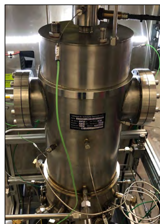
Abbildung 12: Dehydriereinheit mit einer Leistung von 2 kW – 3 kW Wasserstoffenthalpiestrom.
