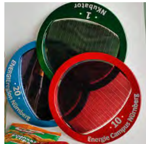
Abbildung 7: Mittels beschleunigtem Rakelprozess hergestellte großflächige OPV-Module.
