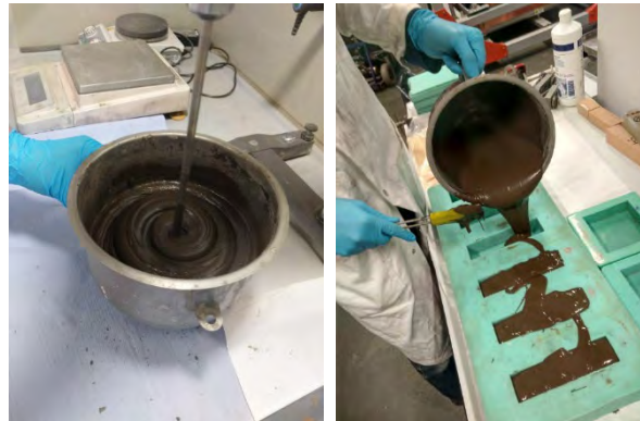
Abbildung 21: Durch Rühren homogenisierte Geopolymer-Paste (l); Einfüllen der homogenisierten Geopolymer-Paste in Prismen-Formen aus Silikon (r)
