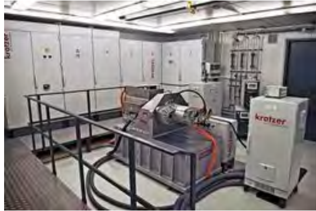
Abbildung 83: Beispiel für einen Hochdrehzahlprüfstand (Bild: www.kratzer-automation.com )
