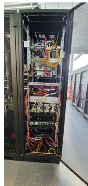
Abbildung 5: Rückseite des CHIL Racks mit den Simulatoren von Speedgoat und OPAL-RT
