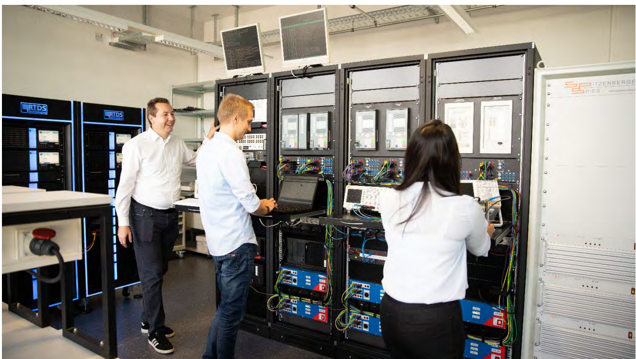
Abbildung 6: Schutzuntersuchungen am Echtzeitsimulator
