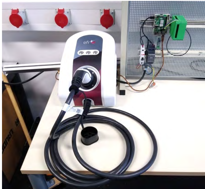
Abbildung 73: Versuchsaufbau für die Entwicklung und Testen der Ladesteuerung im Labor am EnCN.
