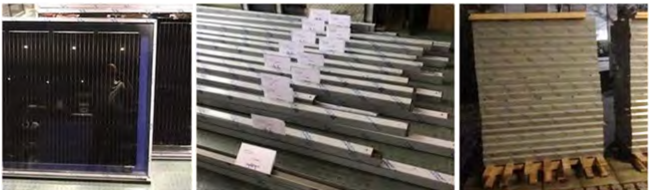
Abbildung 36: Vorgefertigte Fassadentafeln mit integrierten PV-Modulen (links), Lisenenstücke (mittig) und palettierte Fassadenmodule für den Transport (rechts).
