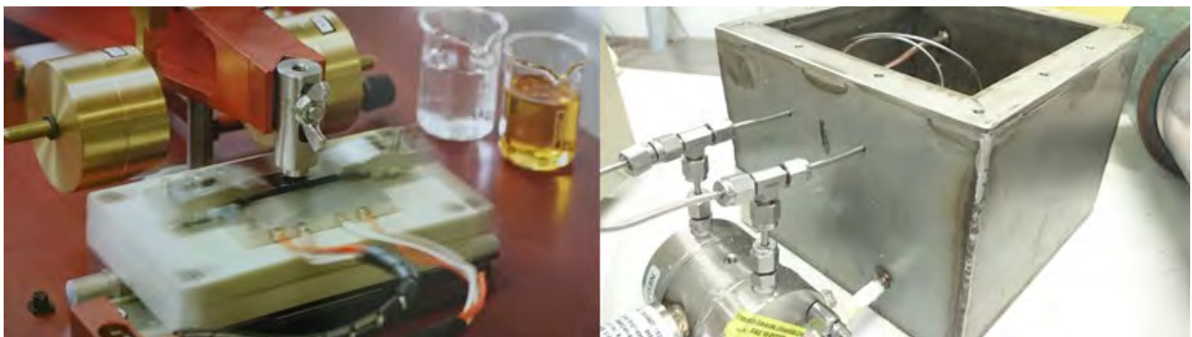
Abbildung 3: Tribometer zur Bestimmung des Reib- und Verschleißkoeffizienten (links) sowie Kapillar-Viskosimeter zur Bestimmung der Viskositäts-Temperatur-Charakteristik (rechts) von Arbeitsfluid-Schmieröl-Paarungen
