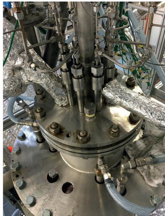
**Abb. 36:** Nickel-Membranbündel und Labor-Heatpipe-Reformer am EVT [68].
