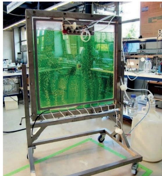
**Abb. 26:** Laborplattenreaktor für optimales Lichtmanagement zur Wasserstoffherzeugung mit Mikroalgenkulturen am KIT innerhalb des BMBF geförderten Forschungsprojekts "HydroMicPro".<sup>42</sup>
