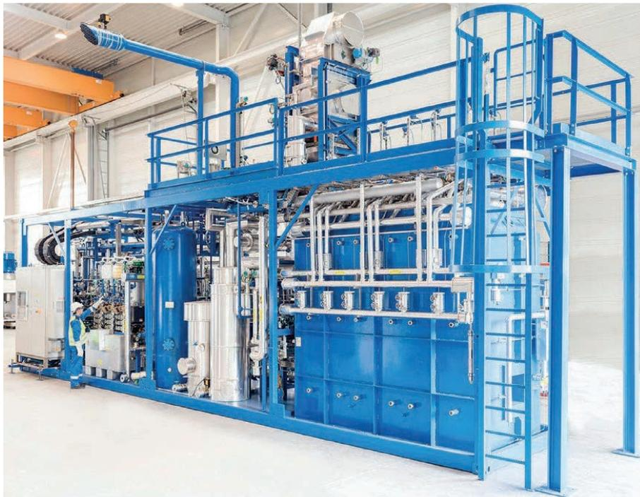
**Abb. 16:** HYDROPRIME-Anlage der Firma Linde bzw. Hydro-Chem zur kleinskaligen Dampfreformierung
