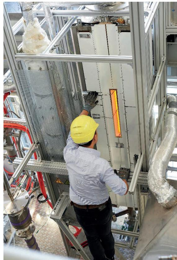
**Abb. 37:** Droptube Reaktor für die Plasmavergasung am EVT [41].
