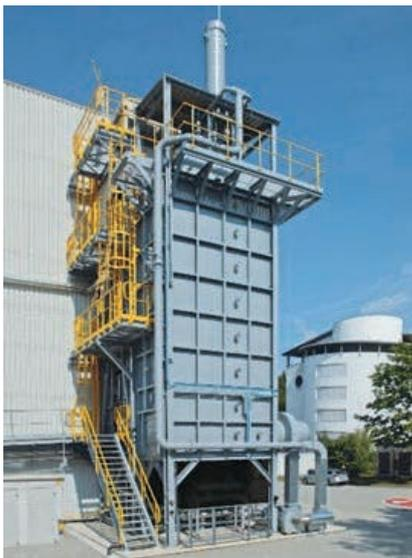
**Abb. 30:** Dry Reforming „pilot reformer“ Anlage der Fa. Linde<sup>45</sup>
