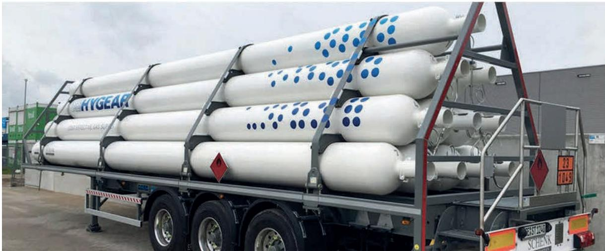
**Abb. 42:** Hochdruckwasserstoff-Tube-Trailer der Firma HyGear (Bildquelle: [fuelcellworks.com](https://fuelcellworks.com))<sup>53</sup>
