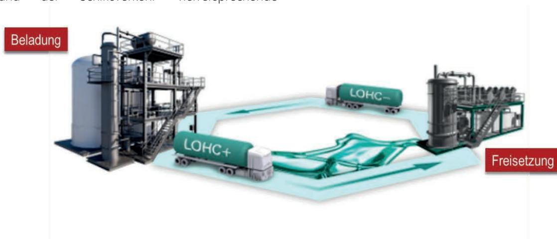
**Abb. 46:** Logistikstruktur für den Transport von LOHCs (Bild: Hydrogenious)
